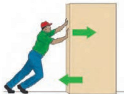
شکل ۲- شخص به جعبه ساکن نیرو وارد می‌کند ولی جعبه حرکت نمی‌کند زیرا نیروی روبه جلوی شخص با نیروی رو به عقب اصطکاک هم‌اندازه‌اند.
