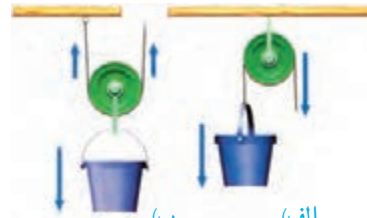
شکل ۱۲ - قرقره ثابت و قرقره متحرک
