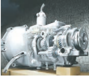
شکل ۱۵ - ترکیب پیچیده‌ای از چرخ‌دنده در جعبه‌دنده خودرو
