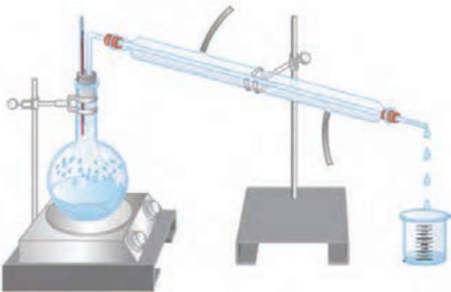
شکل ۲- تقطیر ساده برای جداسازی دو مایعی که اختلاف نقطه جوش آنها زیاد است به کار می‌رود.
